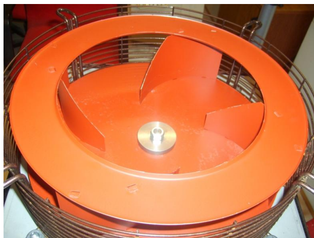
Fig. 1.2 Particolare: girante dell'aspiratore professionale
