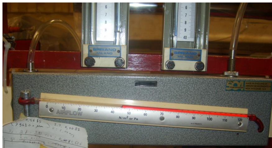
Fig. 1.8 Manometro differenziale a scala inclinata con fondo scala a 120 Pa
